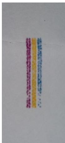
Fig. 16: Amostra de cor liberada durante a limpeza automática do cabeçote de impressão
