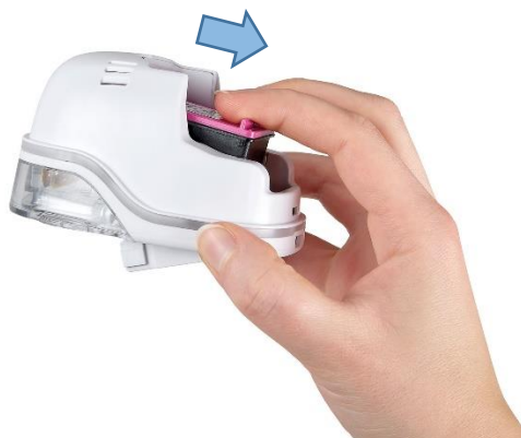
Fig. 28: Extraer el cartucho de tinta
