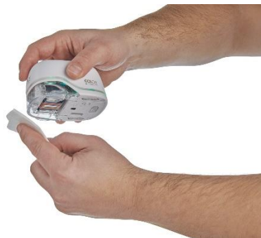
Fig. 19: Limpiar cabezal de impresión con un trapo húmedo
