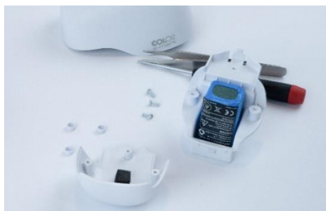
Fig. 39: Abrir la carcasa
