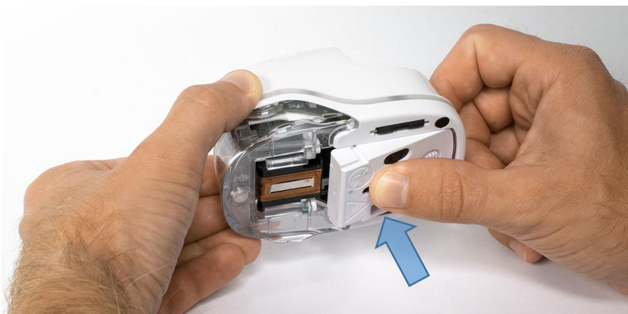
Fig. 31: Cerrar la cubierta abatible inferior
