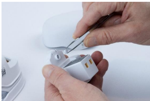
图 36: 拆开电池外壳
