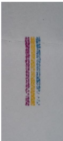
图 16: 在自动打印头清洁时释放出的色样
