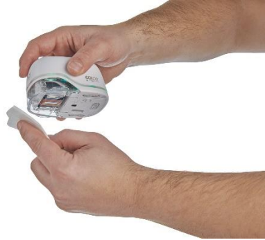
그림 19: 프린트 헤드는 젖은 천으로 청소하십시오
