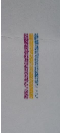
Afb. 16: Kleurpatroon dat bij de automatische printkopreiniging wordt afgegeven
