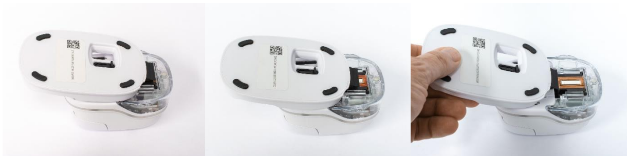
Afb. 18: Printkop reinigen met de wisser
