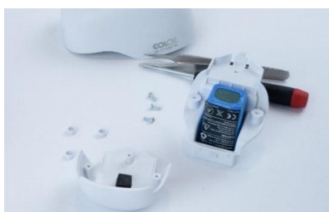
Fig. 39: Abra o compartimento
