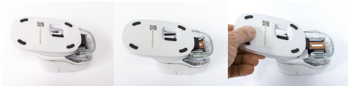
Fig. 18: Limpar o cabeçote de impressão com o limpador
