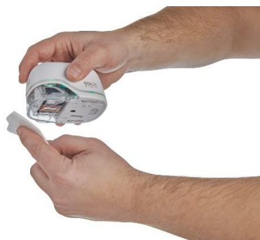
Fig. 19: Limpe a cabeça de impressão com um pano húmido
