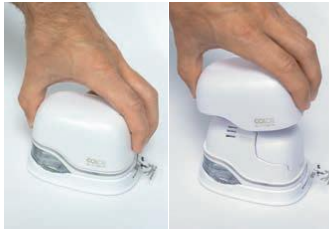
Fig. 23: Abrir e retirar a cobertura
