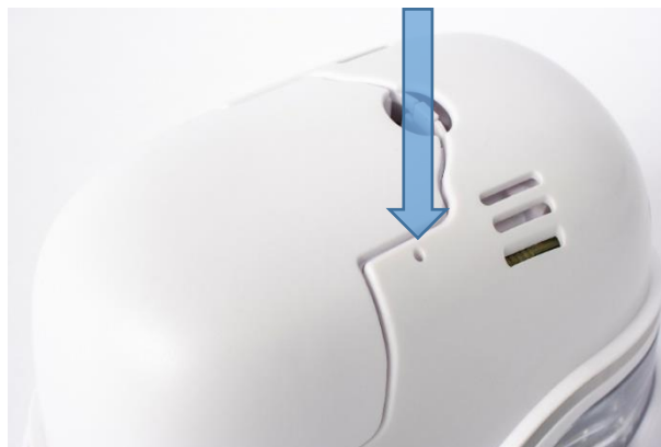
Fig. 35: Orifício para a redefinição do dispositivo
