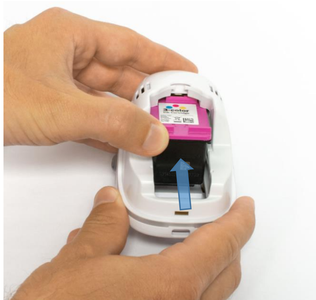
Fig. 30: Inserir o cartucho de tinta
