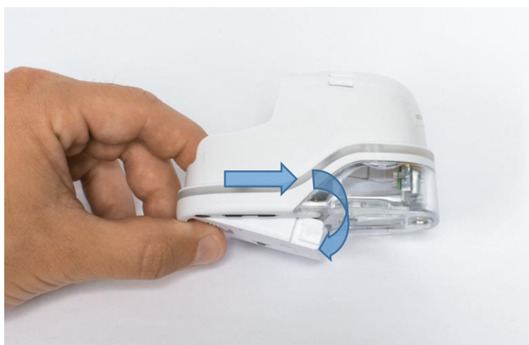
Fig. 27: Compartimento deslizante abierto
