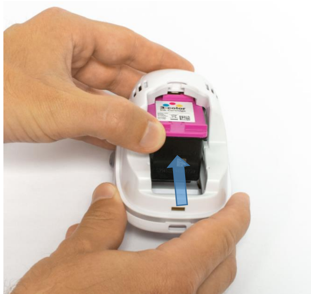
Fig. 30: Coloque el cartucho de tinta
