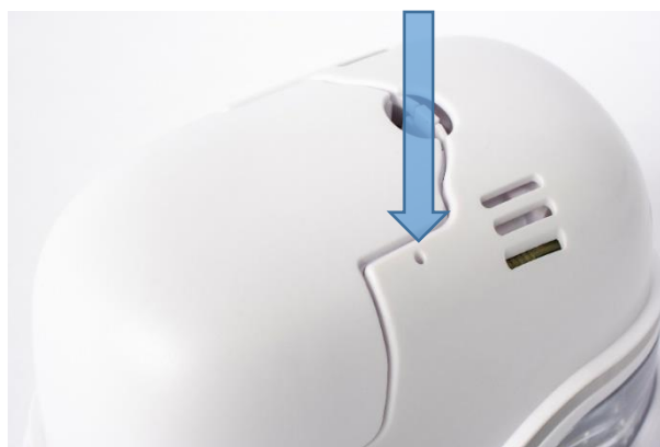
Fig. 35: Abertura para reiniciar el dispositivo
