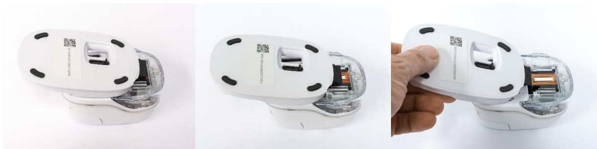
Fig. 18: Limpie el cabezal de impresión con el limpiador
