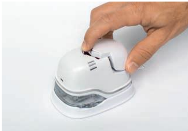
Fig. 25: Abra el compartimento de la batería
