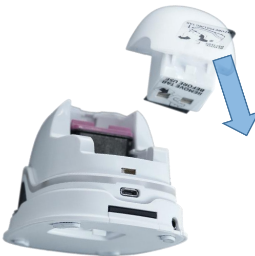
Рис. 6: Ізоляційна стрічка на контактах акумулятора
