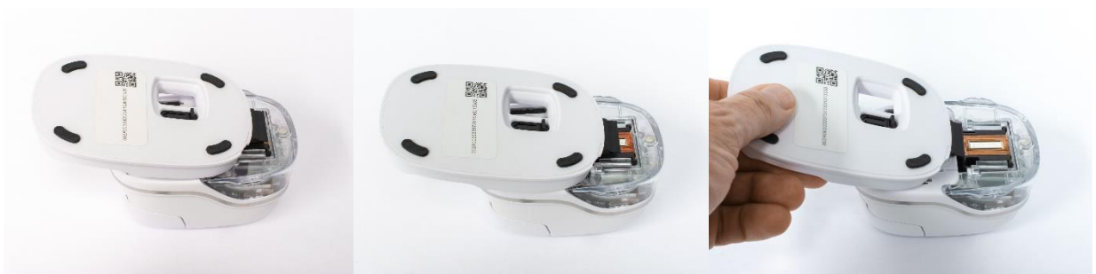
Рис. 18: Очищення друкувальної головки при допомозі очисника
