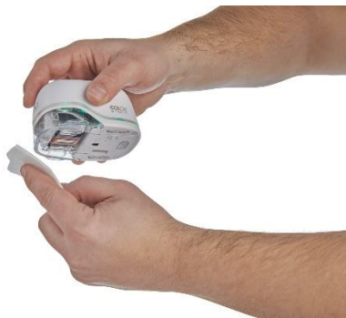
Рис. 19: Очищення друкувальної головки вологою тканиною
