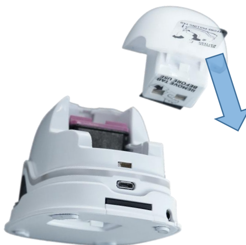
図 9: バッテリー接触絶縁テープ
