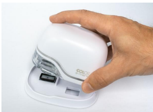
図 17: ドッキングステーションから e-mark を削除します
