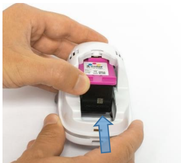
図 43: インクカートリッジを挿入します
