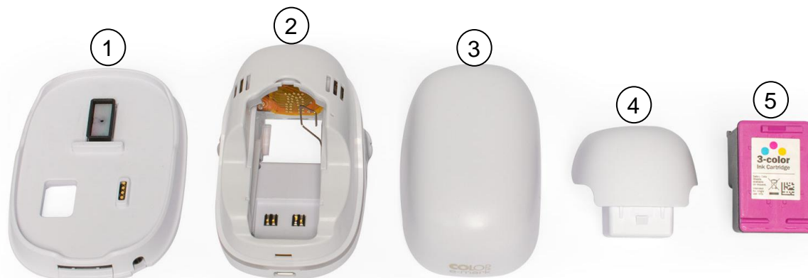
3. ábra: Az e-mark nyomtató részei
