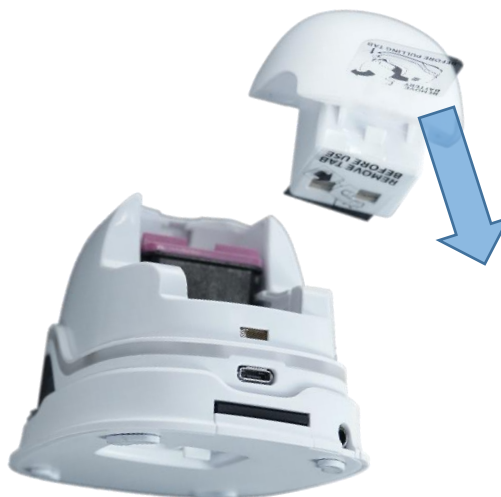
9. ábra: Az akkumulátor érintkezőin levő szigetelőszalag
