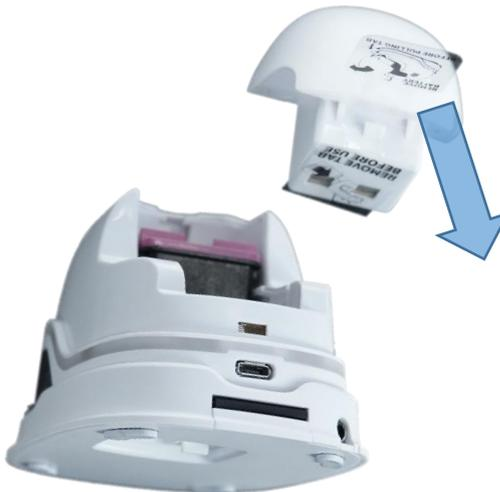
Fig. 6: Pellicola isolante contatti della batteria
