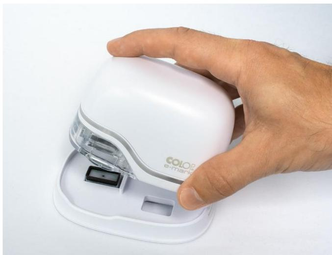
Fig. 34: Posizionamento nella docking station
