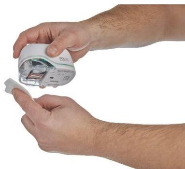
Fig. 19: Nettoyez la tête d'impression avec un chiffon humide
