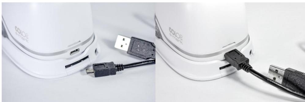
Fig. 20 : Connexion USB
