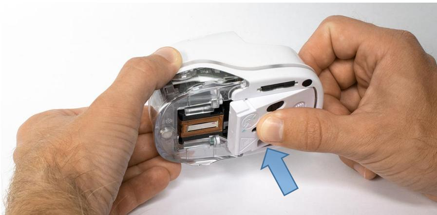
Fig. 31 : Fermer le couvercle à clapet inférieur
