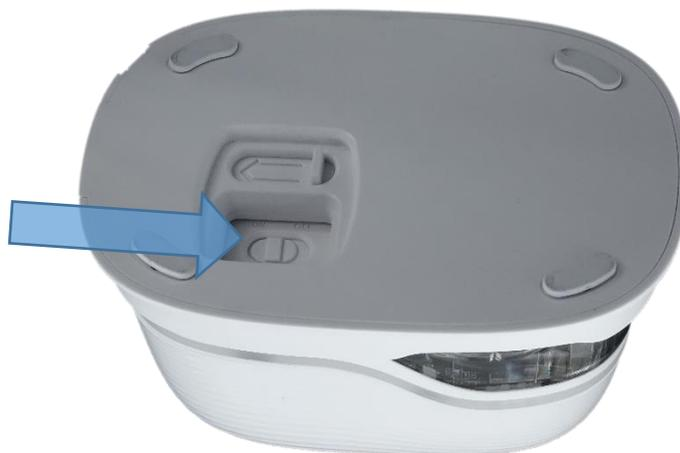
Fig. 8 : Interrupteur marche/arrêt
