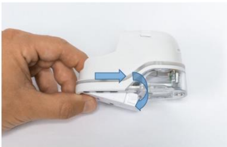
Рис. 40. Отвод выдвижной крышки
