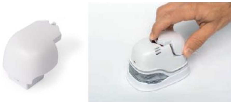
Рис. 8. Разборка батарейного отсека и извлечение батареи
