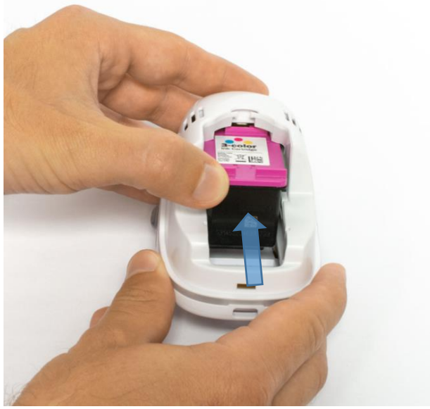
Şekil 44: Mürekkep kartuşunu takın
