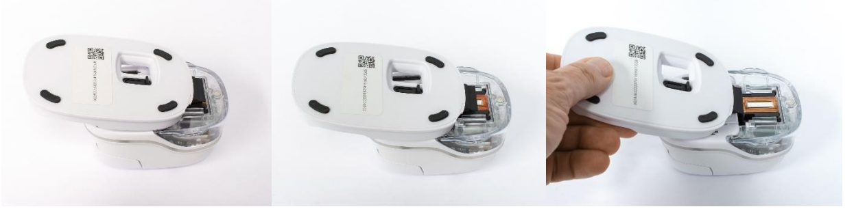
Şekil 27: Baskı kafasını silecekle temizleyin
