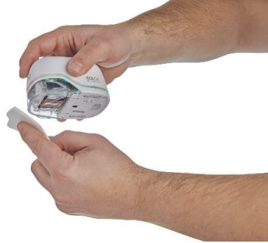
Şekil 28: Baskı kafasını nemli bir bezle temizleyin
