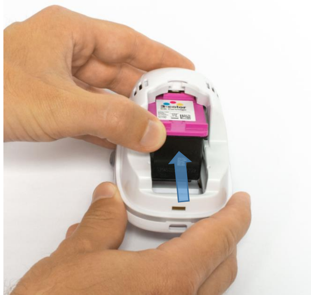
Şekil 12: Mürekkep kartuşunu takın
